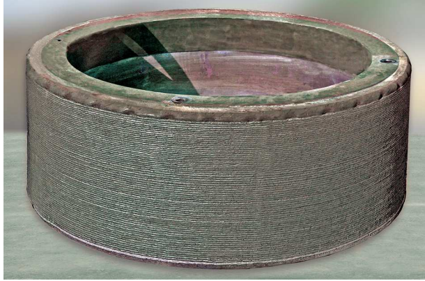
Regenerierte Mahlwalze mit rechteckigem Querschnitt und Einsatz von Hartauftragschweißung KALMETALL-W 100, Durchmesser 1 500 mm
