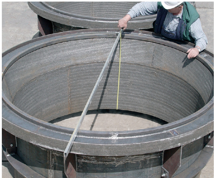
Cône séparateur de ciment d'un diamètre de 3 000 mm à structure autoporteuse en tôles d'acier rechargées en KALMETALL-W 100 6+4
