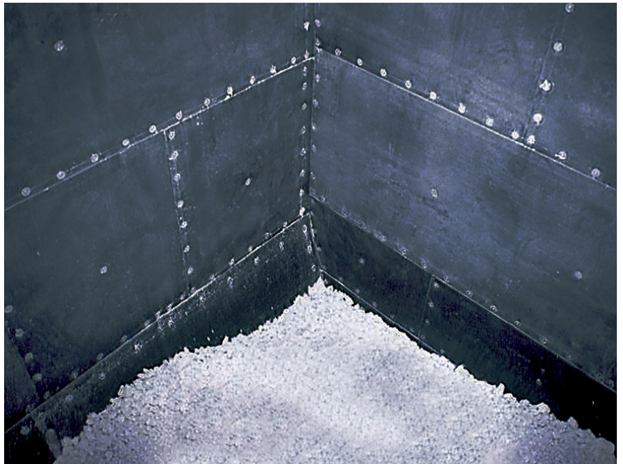
Rohmehlbunker mit gleitfördernder Auskleidung aus Gleitkunststoff KALEN-1006
