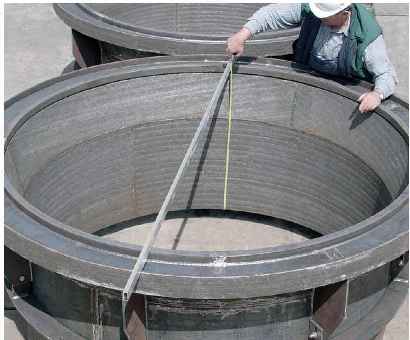
Abscheidekonen von Zementsichtern als selbsttragende Konstruktion mit hartauftraggeschweißten Blechen aus KALMETALL-W 100 6 + 4 – der Durchmesser beträgt 3 000 mm
