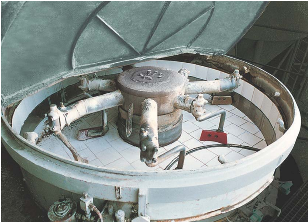
Tellermischer mit Auskleidung aus Oxidkeramik KALOCER in Kombination mit Mischerschaufeln aus KALEN -PU
