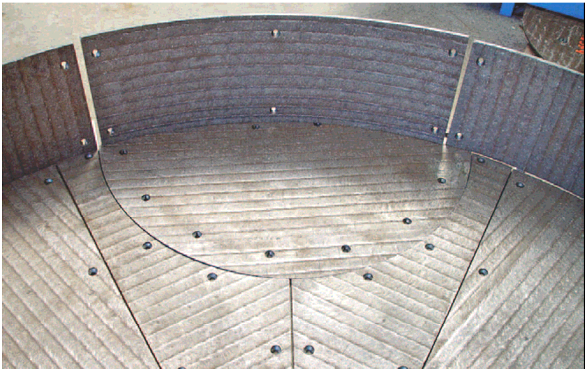
KALMETALL-W Auskleidung mit großen Plattensegmenten sowie guter Anpassbarkeit im Bereich des Austragschiebers
