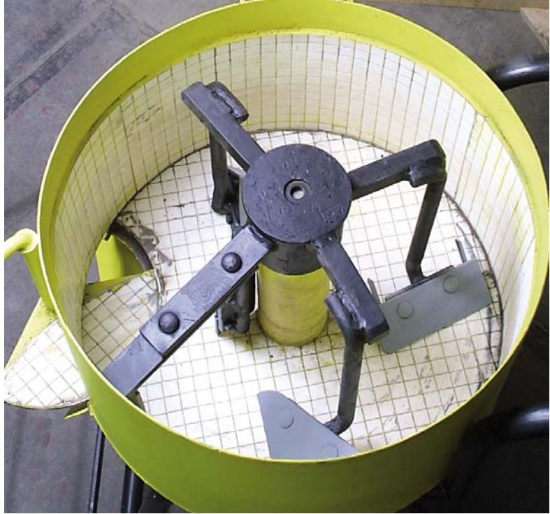
Verschleißgeschützter Zwangsmischer für Baustoffmassen – die Oxidkeramik-Mosaik passen sich gut an die vorgegebene Geometrie an.
