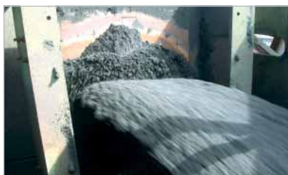
Revêtement KERAFLEX de la trémie d'une installation de transbordement
