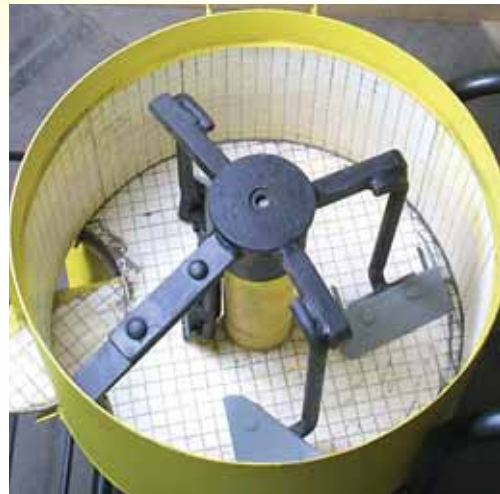
Verschleißgeschützter Zwangsmischer für Baustoffmassen, die Oxidkeramik-Mosaik passen sich gut an die vorgegebene Geometrie an
