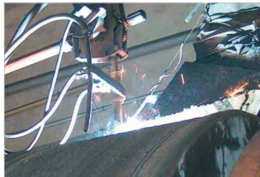
Installation de rechargement de Kalenborn : régénération d'un galet de broyage
