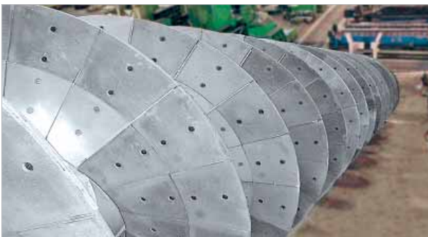
Convoyeur à vis sans fin dans un atelier de granulation de laitier ; revêtement de la vis sans fin en KALMETALL-C 155 ; diamètre de vis 1 200 mm
