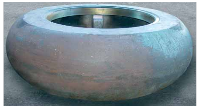
Galet de broyeur vertical à charbon d'un diamètre de 1 500 mm après traitement thermique et usinage de finition
