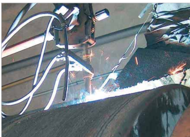
La régénération des galets de broyage est une prestation standard du Service Soudage de Kalenborn
