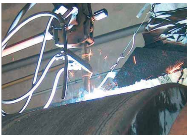
Regenerierung von Mahlrollen sind bewährter Standard des Kalenborner Schweißservice
