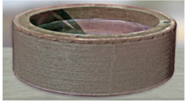
Abb. 16: Regenerierte Mahlwalze mit rechteckigem Querschnitt und Einsatz von Hartauftragschweißung KALMETALL-W 100, Durchmesser 1 500 mm
