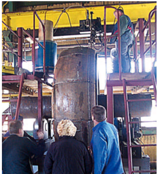
Abb. 18: Mit dem Kalenborner Service werden Mahlrollen mit Hartauftragschweißung KALMETALL-W 100 wirksam regeneriert
