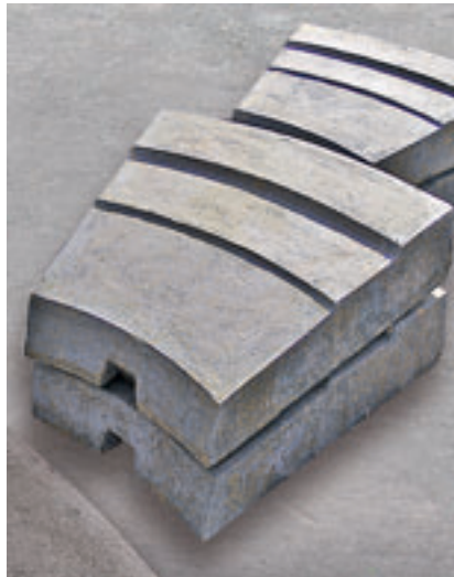
Abb. 12: Mahlteller-Segmente einer Vertikalmühle (5 000 mm Durchmesser) aus KALMETALL-C; kleinere Durchmesser werden in einem Stück gegossen
