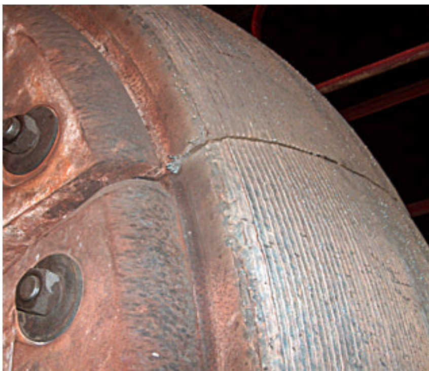
Abb. 13: Mahlrollen-Bandagen können bei großen Durchmessern segmentiert sein, das Bild zeigt die regenerierte Ausführung
