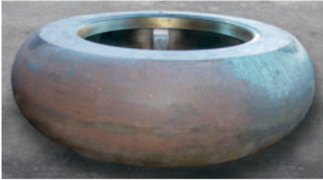
Abb. 14: Für die Mahlsysteme Rohmaterial, Kohle und Klinker liefert Kalenborn neue Mahlrollen; die Abbildung zeigt das gegossene Teil aus Hartguss KALMETALL-C 153, Durchmesser 1 500 mm
