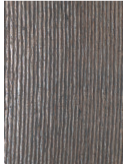
Abb.19: Entwickelte Kenntnisse bei der Regenerierung von Mahlwerkzeugen ermöglichen hervorragende Qualität und Dauerhaftigkeit der Auftragschweißung; die erzeugte Schweißstruktur ermöglicht darüber hinaus ein verbessertes Einzugsverhalten
