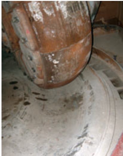
Abb. 10: Die Mahlwerkzeuge unterliegen massiven Verschleißbeanspruchungen; das gilt für die Mahlrollen wie auch die Mahlteller
