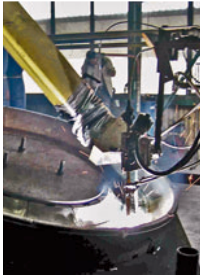
Abb. 17: Regeneration eines verschlissenen Mahltellers in der Kalenborner Spezialwerkstatt
