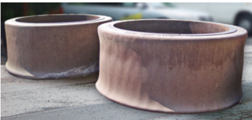
Abb. 1: Der Verschleiß der Mahlrollen in Vertikalmühlen ist erheblich; hier verschlissene Rohmehl-Mahlrollen vor der Regenerierung
