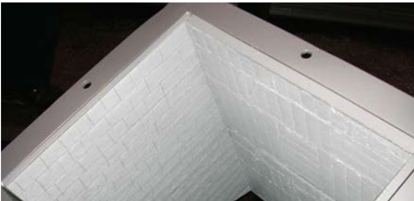
Bunker in einem Zementwerk; die KERAFLEX-WRM Elemente bestehen aus 5 mm Grundblech, 5 mm Gummi und 13 mm Hartauftragsschweißung KALMETALL-W (8 + 5)
